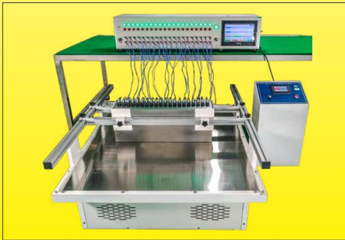
Equipement d'essai permettant de mesurer la résistance au vibration des air switches et des pressostats à rupture lente, par simulation des conditions de transport (Laboratoire Ultimheat)
